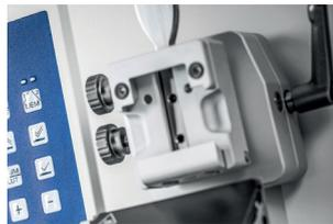
Die Probenorientierung auf der x- und y-Achse ermöglicht eine schnelle Ausrichtung der Proben in die gewünschte Position.
