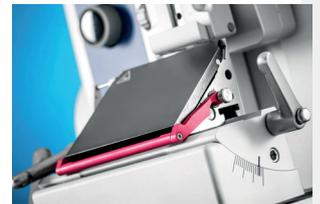
Volle Flexibilität für praktisch jede Art von Proben aufgrund des Einwegklingenhalters oder des Standard-Messerhalters sowie den multiplen Kassettenklammern. Der Klemmhebel und Klingenauswerfer ist umbaubar (von links nach rechts).
